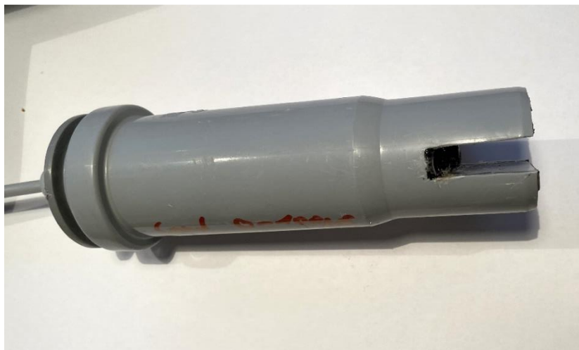
Vergossener Leitfähigkeitsgeber mit integrierter Elektronik
