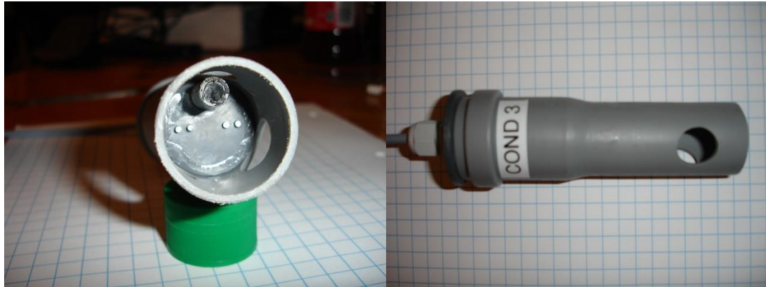
Mechanisch vereinfachte Lösung mit etwas ungünstigerer Feldverteilung
